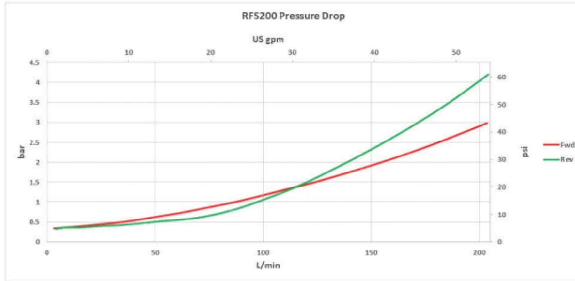
Chute de pression typique avec des raccords 1» BSPP. 1 bar = 14,5 psi, [ISO32 @23cSt].
