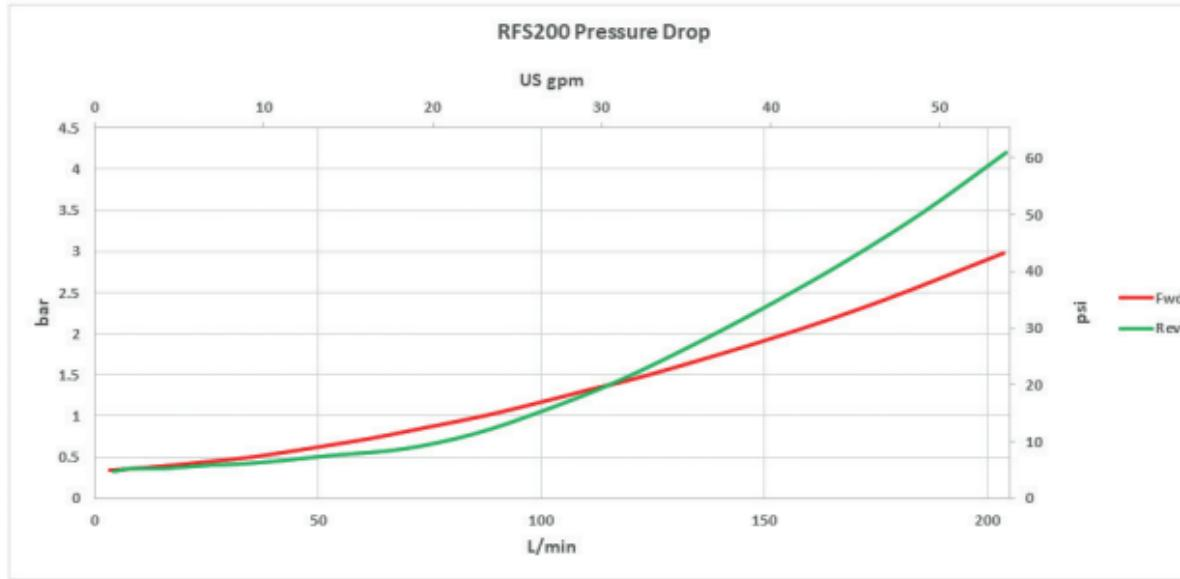
Typischer Druckabfall mit 1" BSPP-Verschraubungen. 1 bar = 14,5 psi [ISO32 bei 23 cSt]
